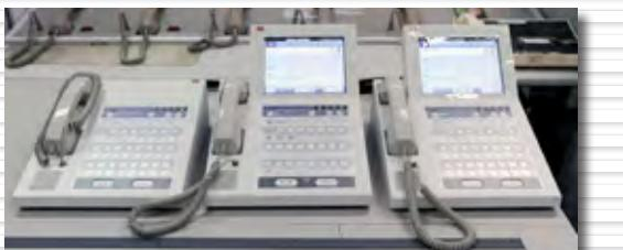
消防指令センターに設置、無線回線制御装置と接続されており、移動局との無線交信に使用します。
